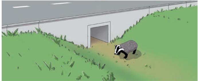
Abb. 55: Durchgänge für Kleintiere bei erhöhten und ebenerdigen Strassen.
