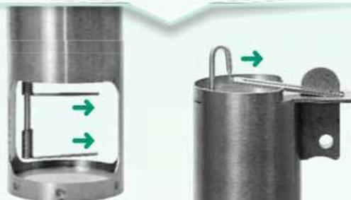
Funktionskontrolle: Falle spannen und kontrollieren, ob beide Auslöser (Abb. links) parallel zur Wippe (Abb. rechts) ausgerichtet sind.
