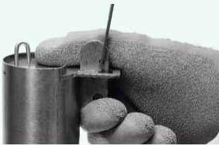
Spannhebel mit Wippe durch den Deckelschlitz bis zum Anschlag hochdrücken.
